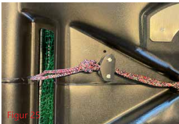
Opptrekkstau notpose posisjon før utsett. Figur 25
